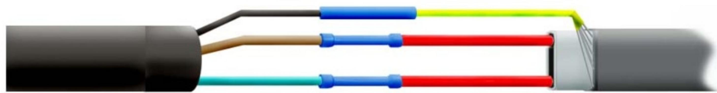
9. Одеть на место соединения термотрубку диам 18мм. усадку начинать с центра к краям
