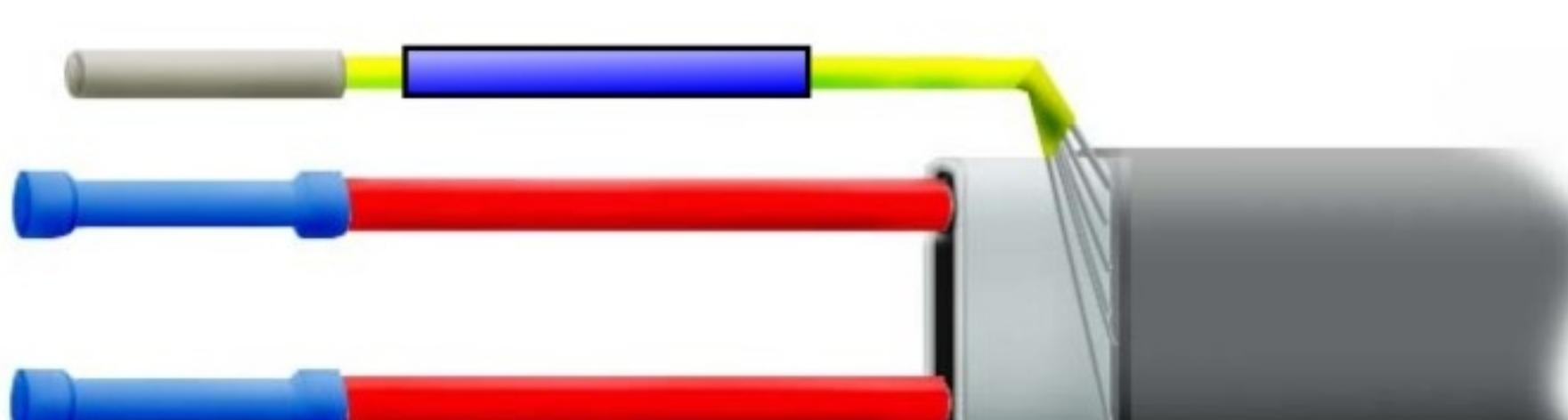
8. Осадить гор. воздухом термотрубку на гильзе
