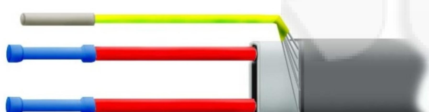
6. На заземляющий провод одеть термоусаживающуюся трубку диаметром 6мм.
