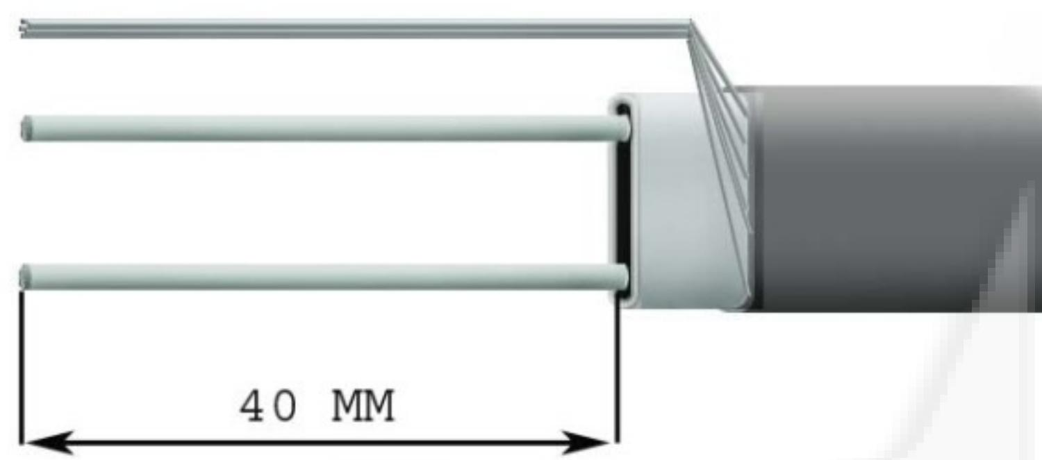
4. Одеть термотрубки (на жилы диам 2-3 мм на заземление диам 4 мм) осадить горячим воздухом
